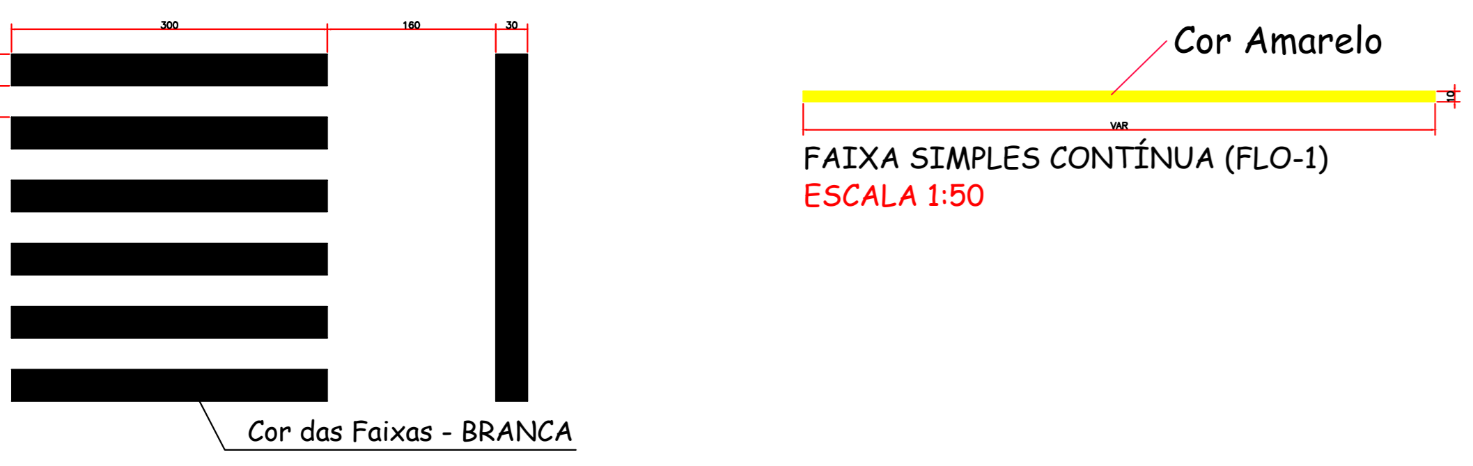
DETALHE - FAIXA DE SEGURANÇA PARA PEDESTRE ESCALA 1:50
