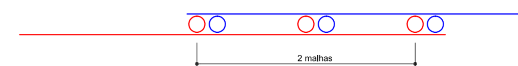
DETALHE DA SOBREPOSIÇÃO DOS PAINÉIS DE TELAS SOLDADAS
