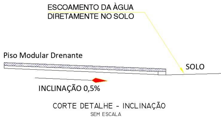
Figura 04 – Detalhe genérico da drenagem (Fonte: Autor/2024)
