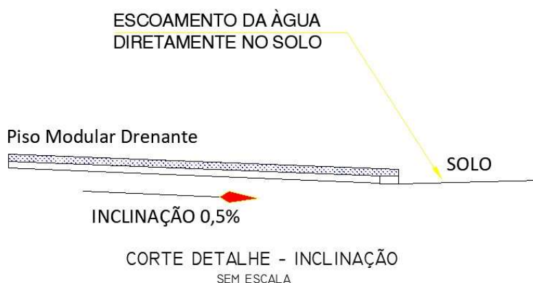
Figura 04 – Detalhe genérico da drenagem (Fonte: Autor/2024)
